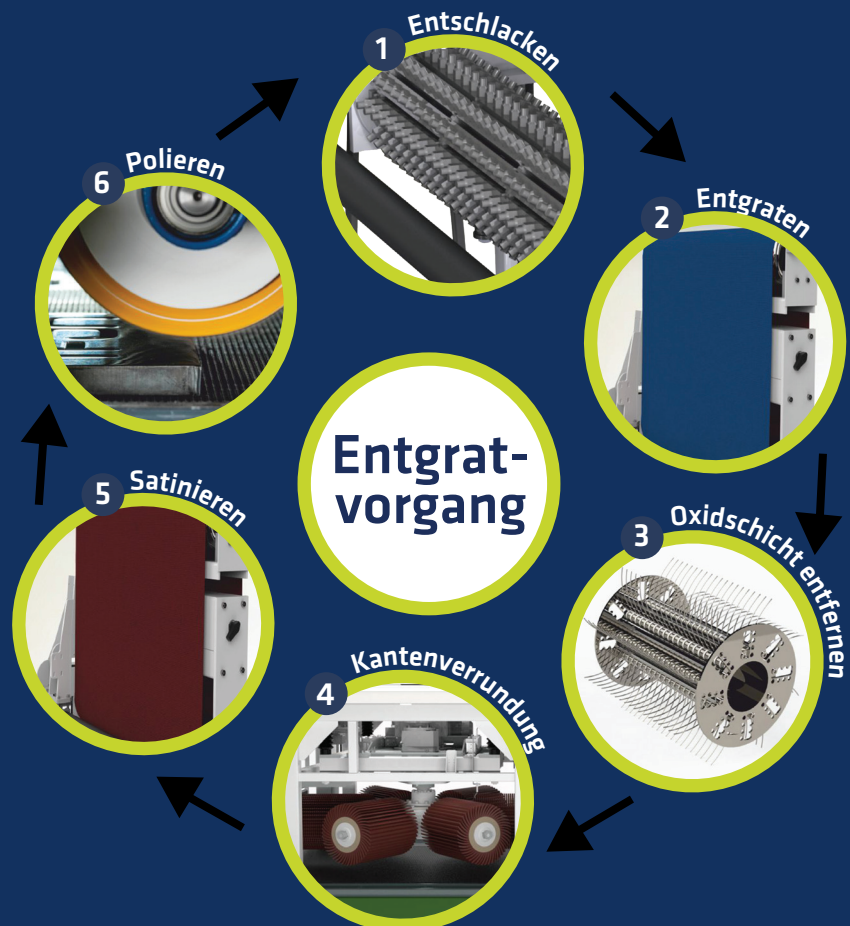
Beispiel Modulaufbau mit 3 Modulen: 2 Entgraten, 4 Kantenverrundungen und 5 Satinieren.
